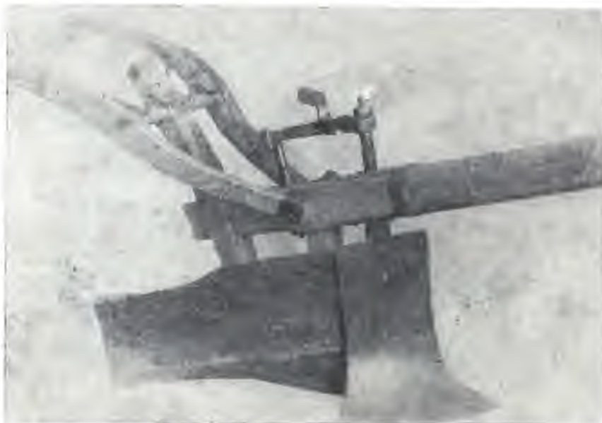
Ryc. 8. Pług dwustronny z ruchomą radlicą w kształcie łopaty i z dwoma ruchomymi odkładnicami żelaznymi; okolice Wałbrzycha (Dz. Etnogr. Muzeum Śl. we Wrocławiu).
